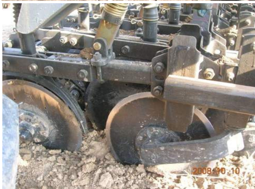
شکل ۳- بذر کار No-Till (با پیش بر بشقابی صاف و شیار بازکن دو بشقابی)
